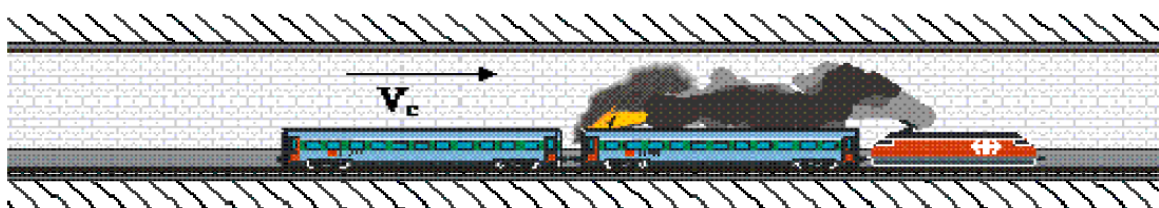
Obr. 3 Kritická rychlost V_c , požadovaná pro zabránění vzniku backlayering jevu (otáčení kouře)
